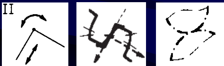
Rys. Liczba stopni swobody, schemat ideowy i symboliczny zazębienia
