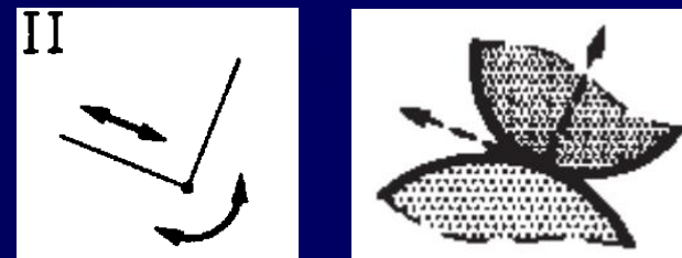
Rys. Liczba stopni swobody i schemat ideowy krzywki i popychacza
