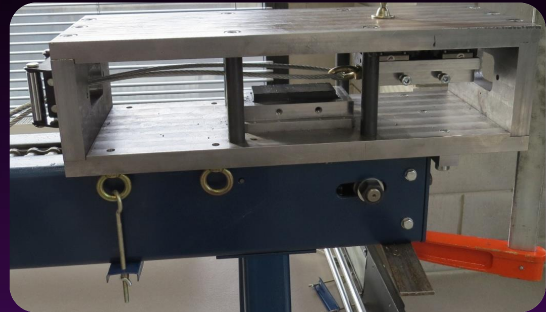
Rys. 4. Przyrząd do walcowania gwintów odkuwek wkrętów w warunkach laboratoryjnych
