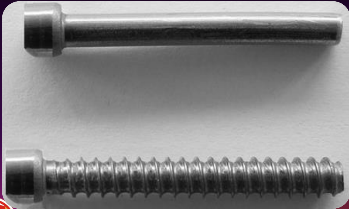
Rys. 14. Ukształtowana przedkewka wkrętu medycznego z odkutym łbem walcowym i odkuwka wkrętu z gwintem pierścieniowym ze stali 316 LVM
