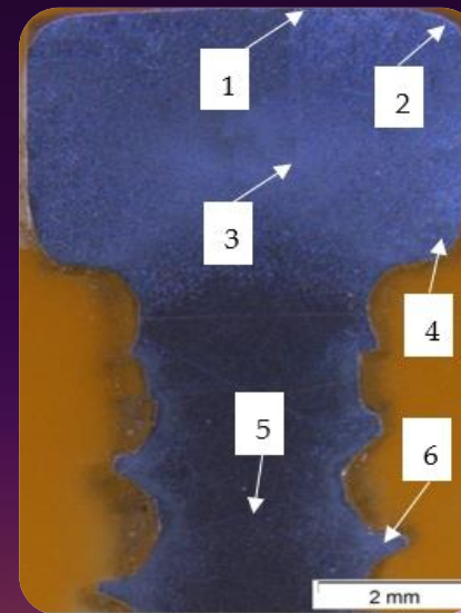
Rys. 11. Przekrój wkręta walcowanego po procesie trawienia
