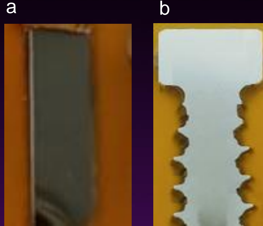
Rys. 8. Zglądy metalograficzne wykonane na przekrojach wzdłużnych: a) drutu (materiał surowy), b) wkrętu
