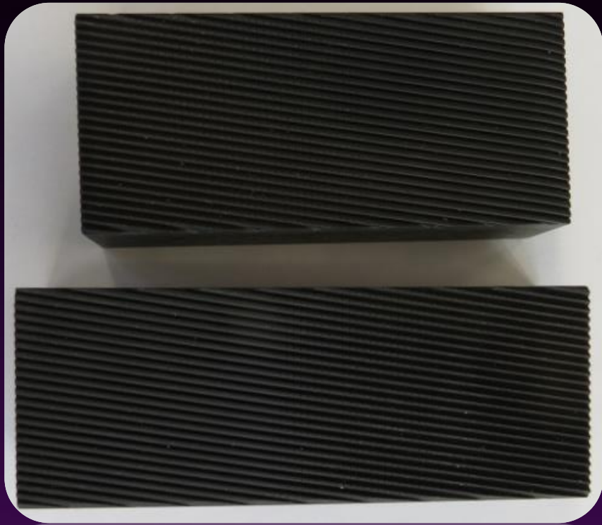
Rys. 5. Zestaw szczęk do walcowania gwintów pierścieniowych odkuwek wkrętów
