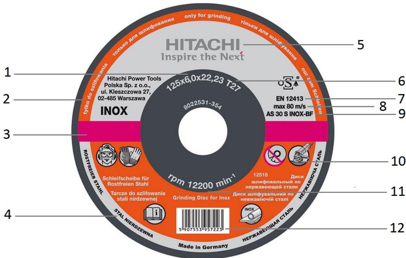
Rys. 10. Oznaczenie przykładowej ściernicy konwencjonalnej: 1 – Wymiary narzędzia; 2 – Ograniczenia; 3 – Barwny pas; 4 – Przeznaczenie; 5 – Nazwa producenta, 6 – Typ i kształt narzędzia; 7 – Norma bezpieczeństwa; 8 – Dopuszczalna prędkość obwodowa; 9 – Oznaczenie artykułu (rodzaj ziarna, numer ziarna, twardość, typ spoiwa); 10 – Piktogramy; 11 – Dopuszczalna prędkość obrotowa; 12 – Kod EAN (Hitachi Group)
