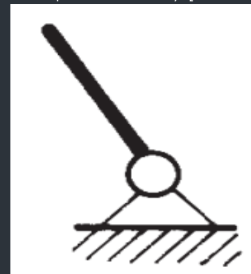
Rys. 2. Rodzina 5 – jeden stopień swobody [Miller 1989]
