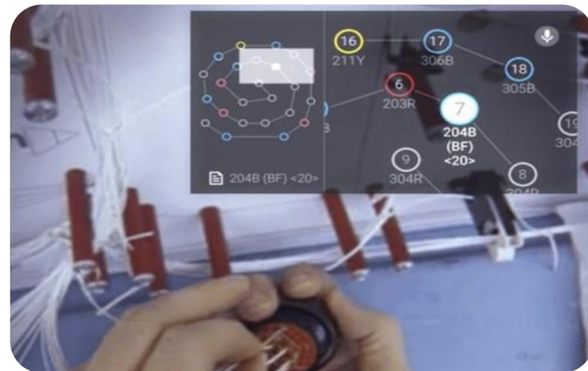
Boeing eksperymentujący z Google Glass w montażu wiązek kablowych do samolotów
