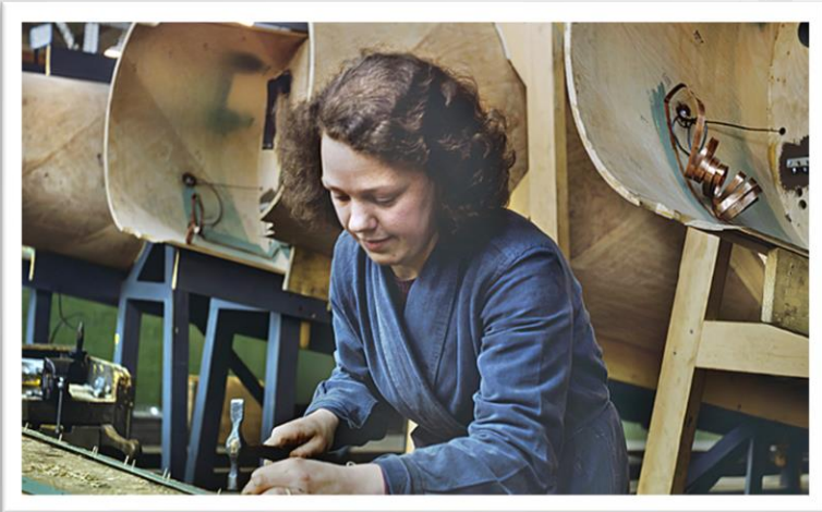
Produkcja drewnianych elementów kadłuba samolotu DH.98 Mosquito
