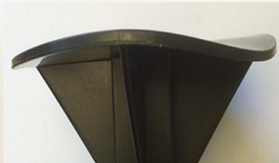
Zdeformowane wypraski wtryskowe
