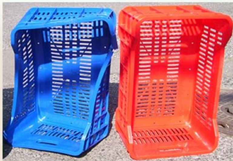
Zdeformowane wypraski wtryskowe
