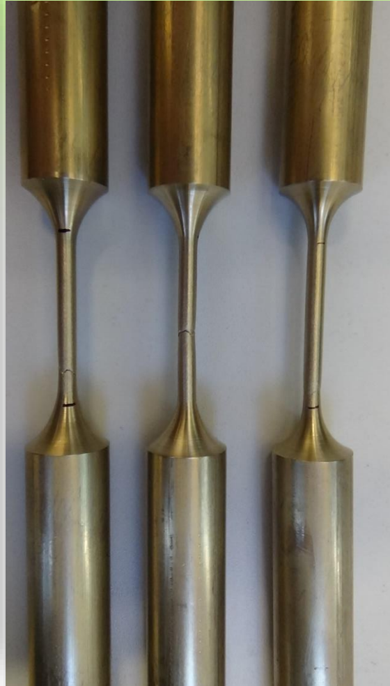
Rysunek 9. Widoki elementów po przeprowadzonej próbie rozciągania, spęczania i skręcania (kolejno od lewej)
