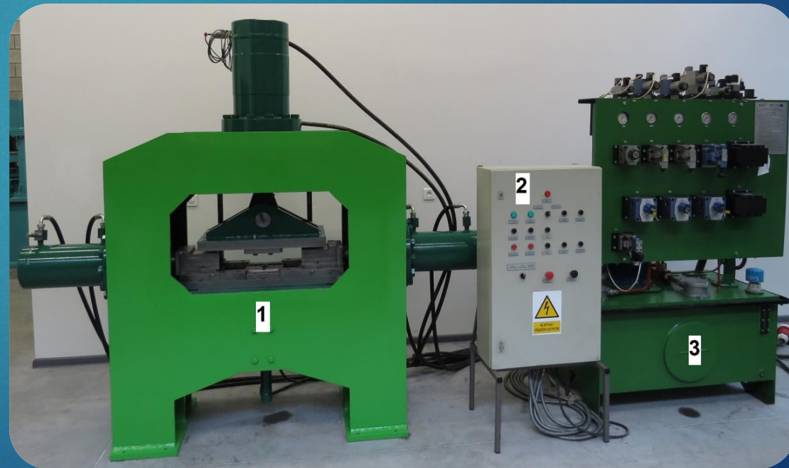
Rys. 10. Trójsuwakowa prasa kuźnicza i przykładowe komplety narzędzi do badań
