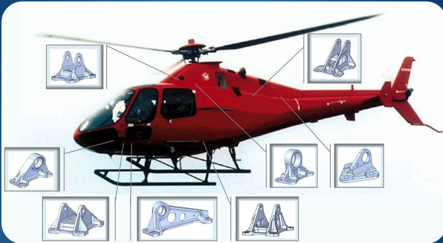
Rys. 2. Lokalizacja części uźebrowanych ze stopów magnezu wytwarzanych z odlewów wykorzystywanych w budowie śmigłowców
