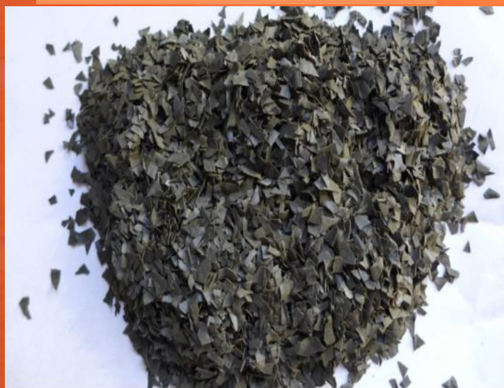
Wygląd rozdrobnionych mechanicznie zraszalników
