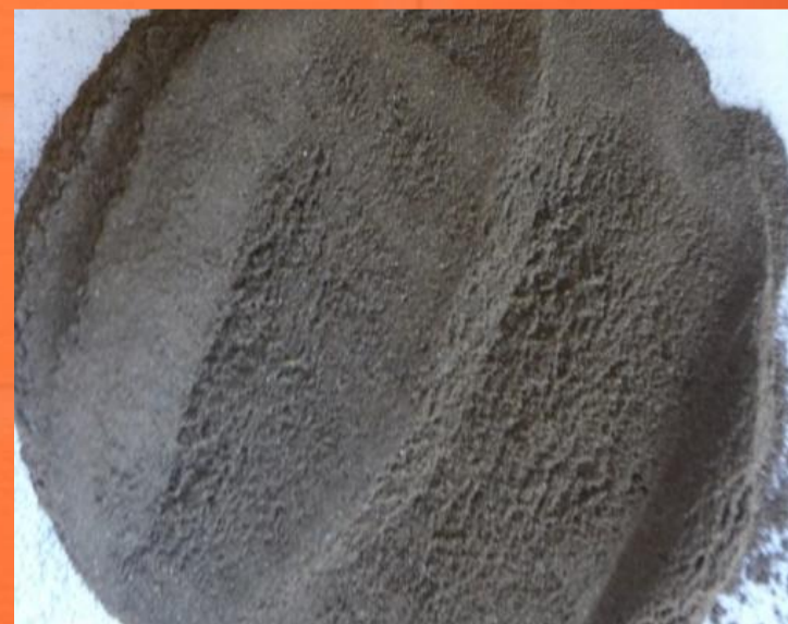
Wygląd osadu mineralnego usuniętego mechanicznie ze zraszalników
