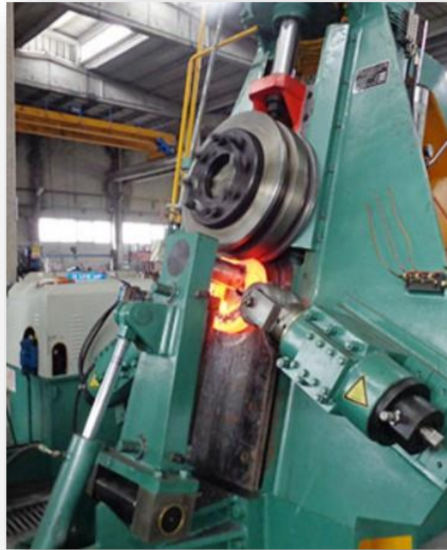
Rys.3. Promieniowe walcowanie pierścieni
