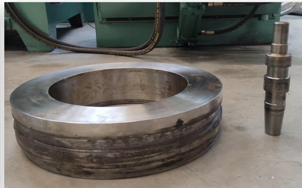
Rys.22. Narzędzia z podcięciami technologicznymi
