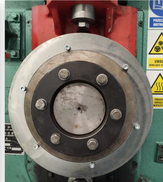
Rys. 43. Składany walec główny
