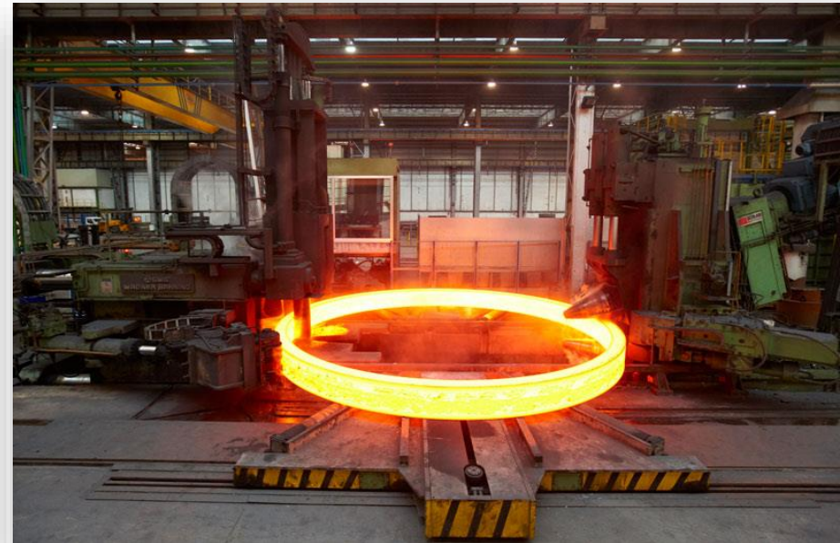
Rys.4. Promieniowo-osiowe walcowanie pierścieni
