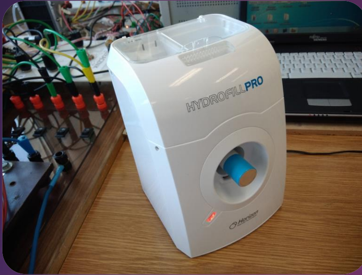
Rys. 3. Zbiornik i butla z wodorkiem metalu podczas napełniania i zasilania ogniwa paliwowego
