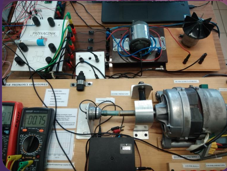
Rys. 8. Stanowisko do badania układu „ogniwo paliwowe – silnik elektryczny”
