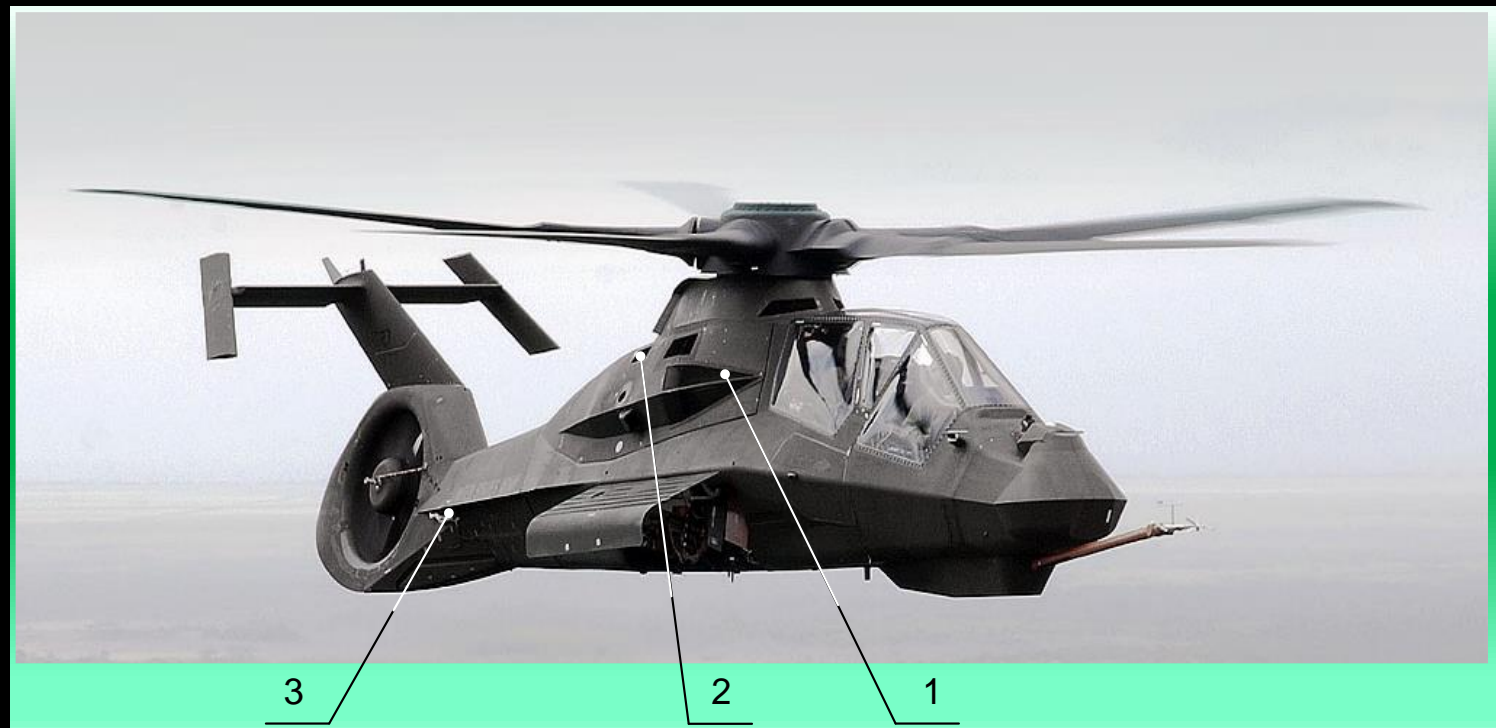
Prototyp RAH-66 Comanche w locie: 1 - wlot powietrza do silnika, 2 - wlot powietrza do schładzacza spalin, 3 - układ wydechowy.
