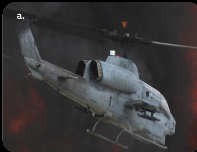
Belka ogonowa AH-1 Super Cobra w podczerwieni, a - bez modyfikacji układu wydechowego, b - z systemem HIRSS: 1 - dyfuzor spalin, 2 - spaliny, 3 - belka ogonowa
