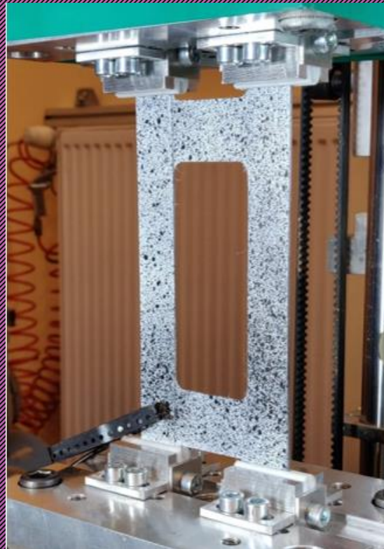
Rys.5. Osiowe ściskanie płyt z wykorzystaniem maszyny wytrzymałościowej Zwick/Roell Z050
