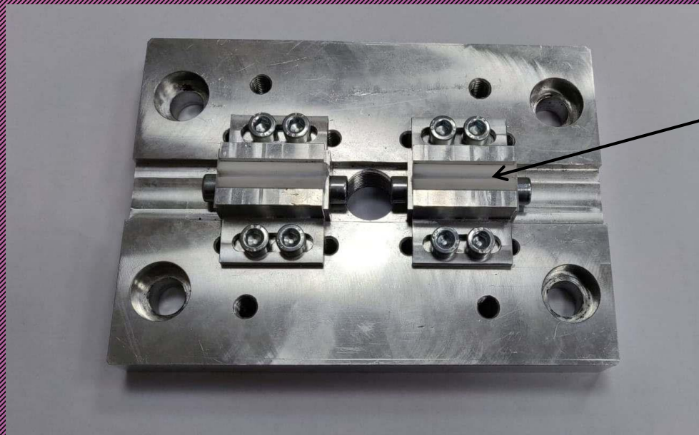
Rys.6. Uchwyt zapewniający przegubowe podparcie końców płyty
