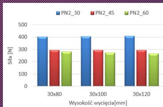
Rys.9. Zależność siły krytycznej od wysokości centralnego wycięcia i trzech różnych kątów ułożenia włókien, dla stałej szerokości wycięcia wynoszącej 30 mm: a) konfiguracja PN1, b) konfiguracja PN2, c) konfiguracja PN3
