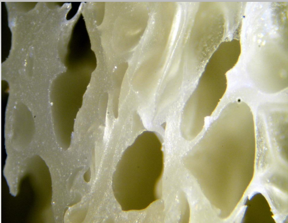
Wygląd mikrostruktury powłoki warstwowej, zawierającej środek porujący w ilości 0,6% mas, powiększenie x 200
