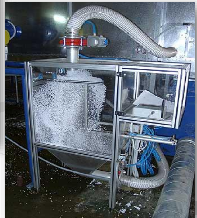
Wygląd ogólny stanowiska rozrastania wstępnej granulatu PS oraz automatycznego układu kontroli procesu rozrastania
