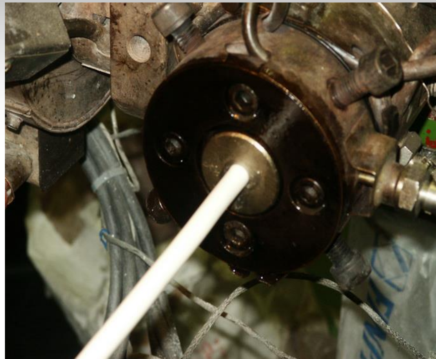
Rys. 4.63. Wygląd fragmentu otrzymanego kabla przy zastosowaniu układu porującego (Hydrocerol PLC 751) w ilości 0,6% masowych
