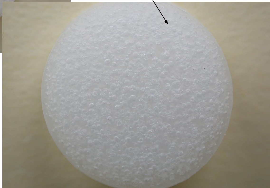
Wytłaczanie metodą porowania swobodnego; PVC
