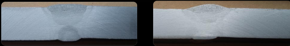
Złącza doczołowe TIG i MAG, grubość 10 mm
