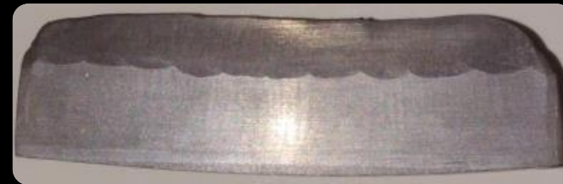
Napoina wykonana drutem proszkowym, grubość podłoża 15 mm
