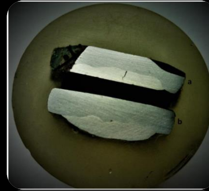
Próbka napawana stellem 1, bez międzywarstwy i z międzywarstwą 308LSi. Przed i po zgnioście.
