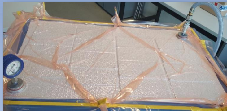
Rys. 11. Widok sklejonych próbek w worku próżniowym
