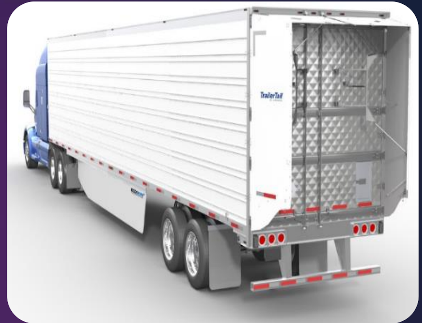
Przykład „sztucznego” ogona dobudowanego do struktury istniejącej naczepy, TrailerTail.
