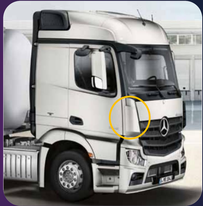
Przykładowy deflektor powietrzny, stosowany seryjnie w ciągniku siodłowym Mercedes Actros.
